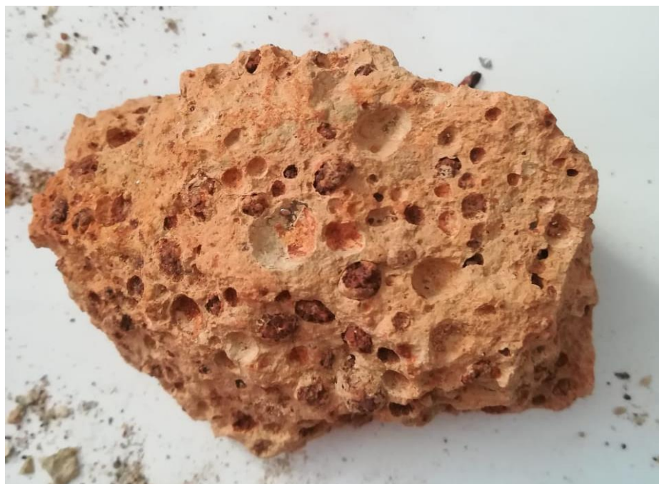
Рисунок 7 – Боксит розового цвета, сухаристый, редкобобовая структура
