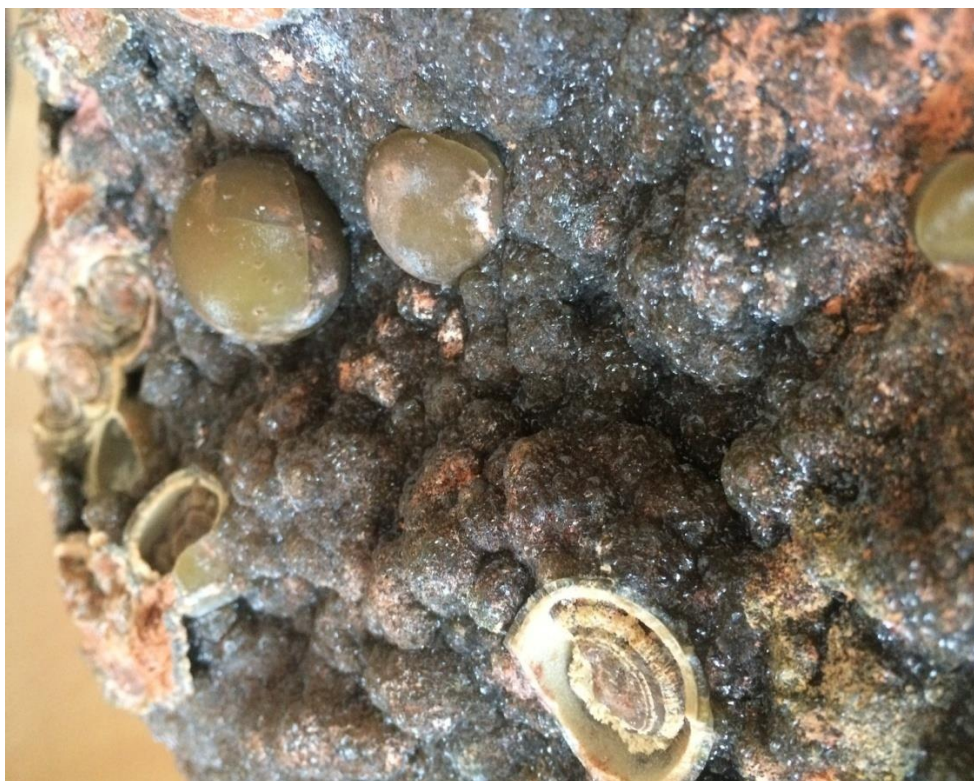
Рисунок 9 – Боксит каменистый с инкрустированным кристаллическим сидеритом
