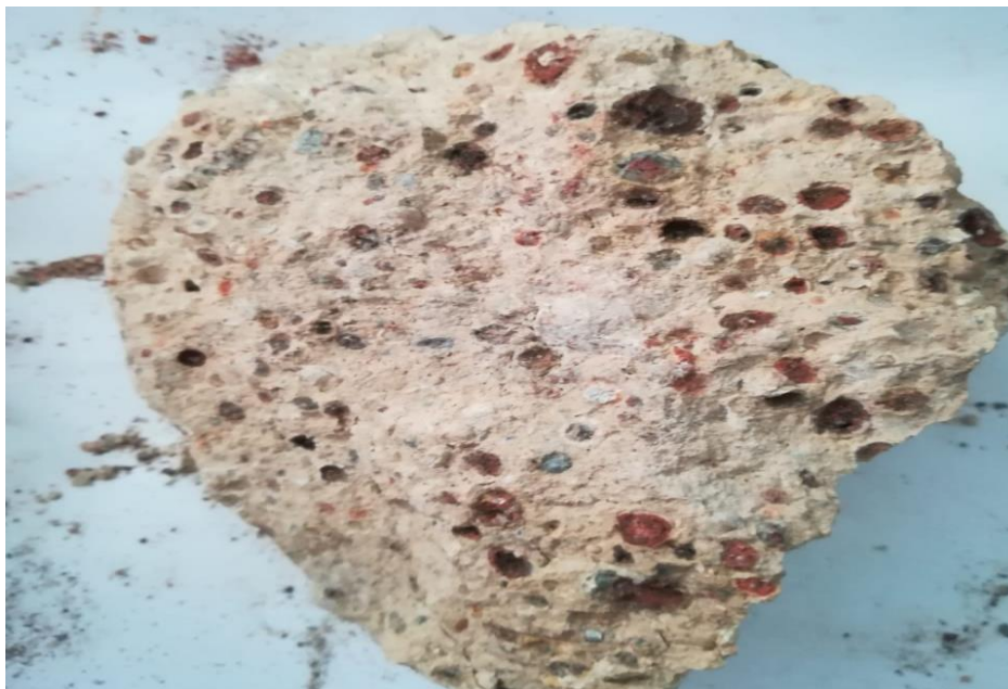
Рисунок 6 – Боксит рыхлый светло-розового цвета, редкобобовая структура
