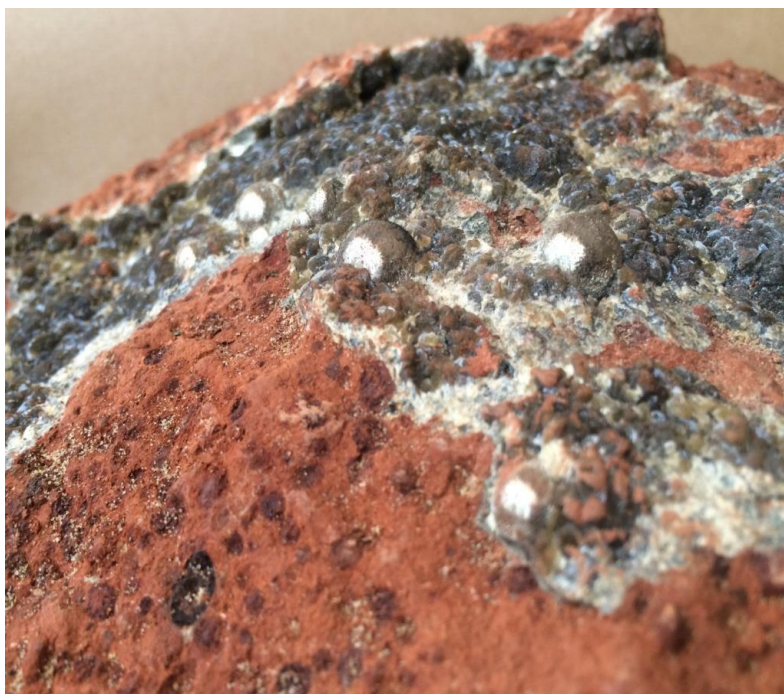
Рисунок 10 – Боксит каменистый сложен мелкокристаллизированным сидеритом
