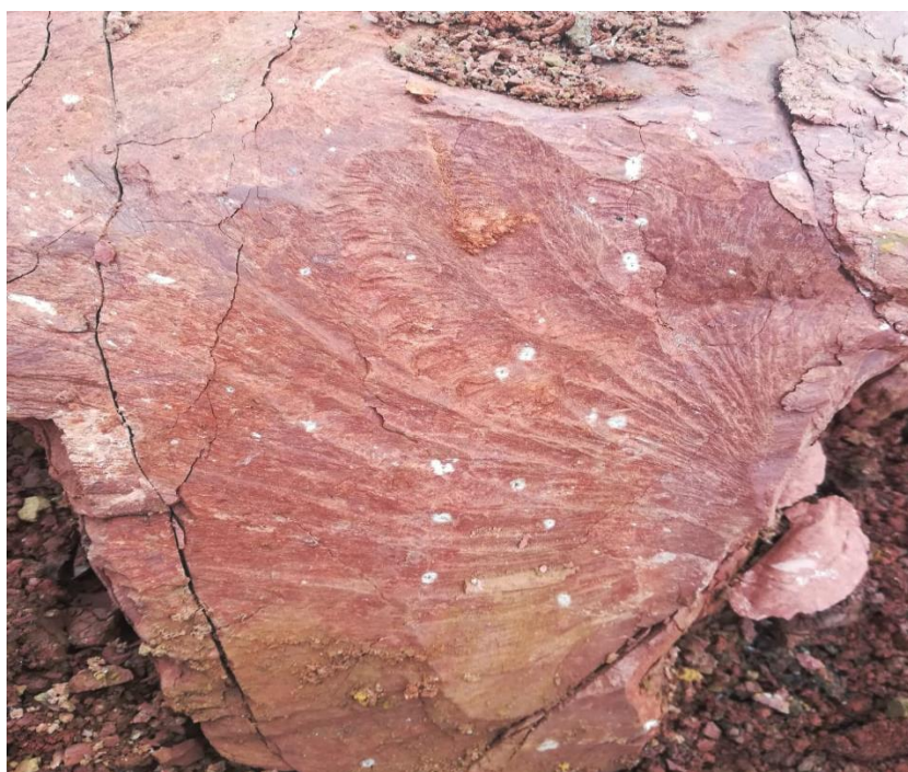
Рисунок 8 – Боксит глинистый красно-бурого цвета с землистым изломом, редкобобовая структура
