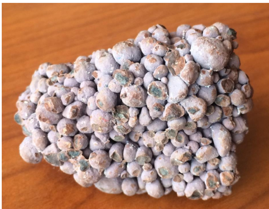
Рисунок 4 – Боксит лишен цемента полностью из бобовин, полнобобовая структура
